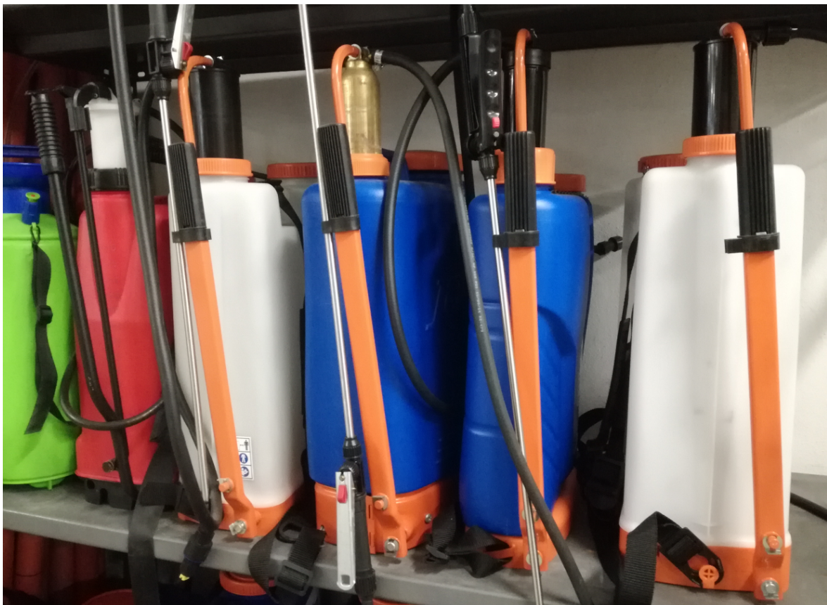
Spritzgeräte zum manuellen Ausbringen von Pflanzenschutzmitteln
