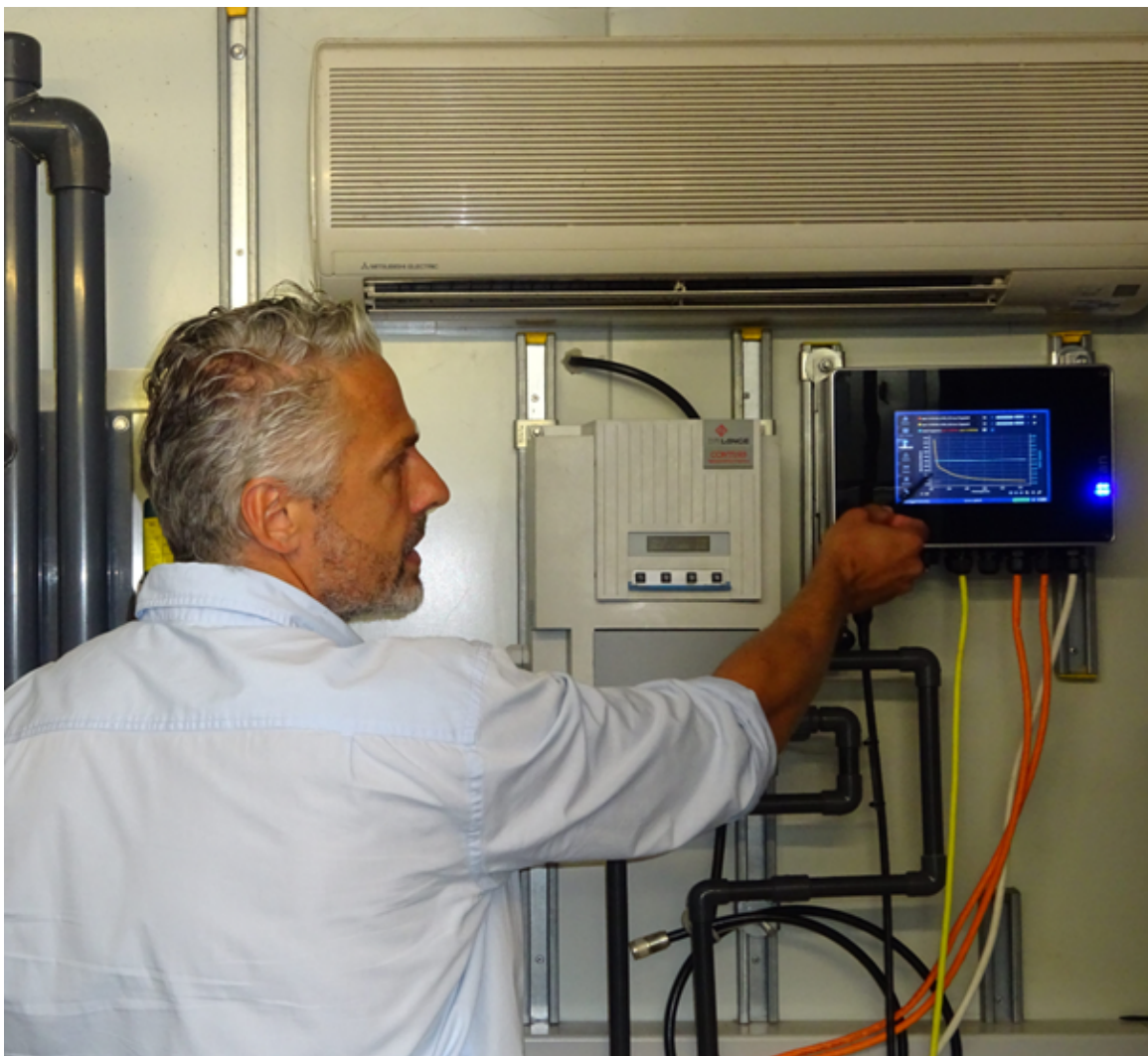
Online-Messstation Wolfsthal, Betriebsführer Dr. Stefan Schuster mit Datenerfassungs- und vor-Ort-Visualisierungseinheit
