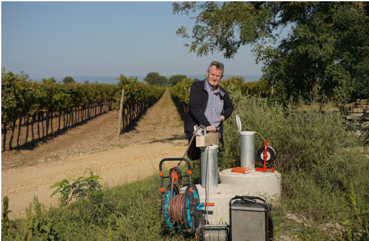
Probenahme an neuer Messstellensonde
