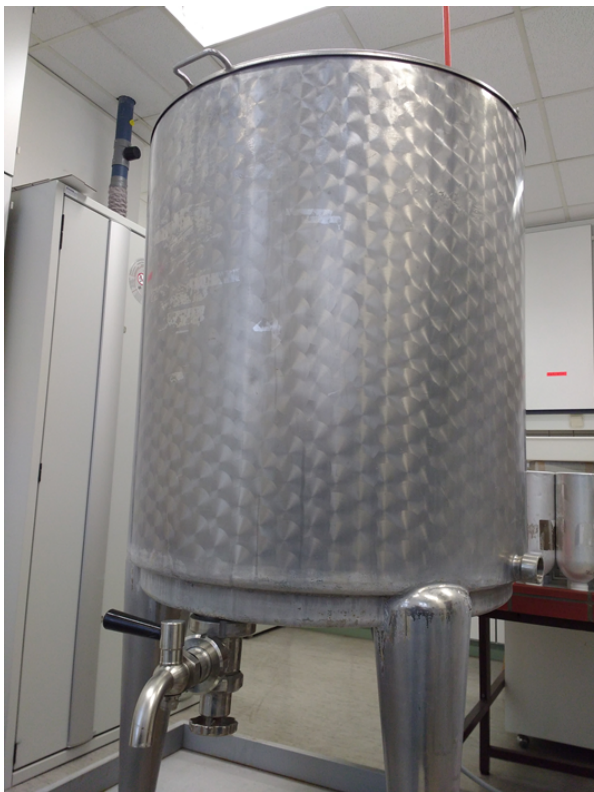
Rührkessel: Vorbereitung der Proben für die Ringversuche (linkes Bild), Probefläschchen (rechtes Bild)
