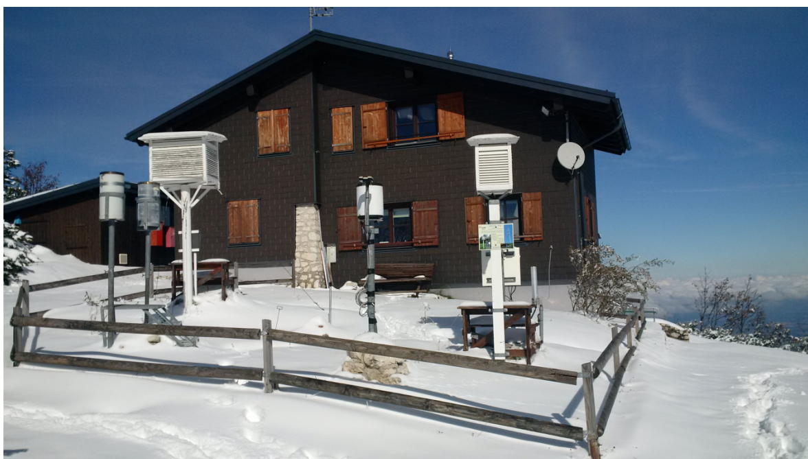
Wetterbeobachtungsstation mit Niederschlagsammler für Isotopenmessung am Feuerkogel (1.598 m) in Oberösterreich
